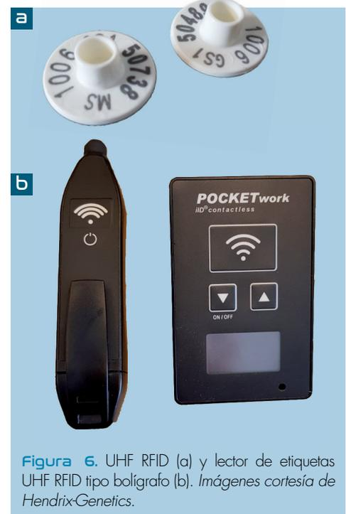
Figura 6. UHF RFID (a) y lector de etiquetas UHF RFID tipo bolígrafo (b). Imágenes cortesía de Hendrix-Genetics.
